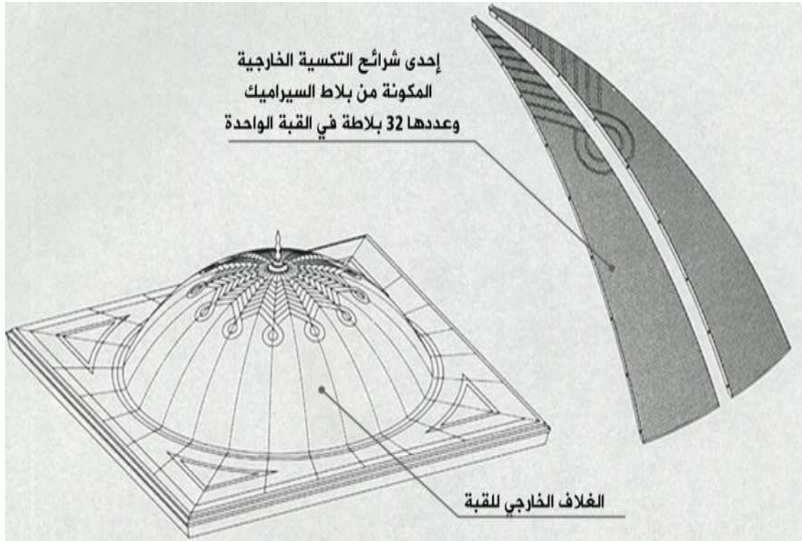
الشكل رقم (21) منظور للقبة المتحركة وموضحاً عليها تفصيلية لبلاطتين من أصل 32 بلاطة من أجزاءها للغلاف الخارجي الخاص بالقبة. Source: The Architecture Of The Prophet's Holy Mosque Al Madinah – Dr.Muhammad Kamal Ismail-Hazar- page 192
