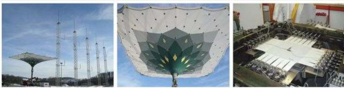
الشكل رقم (16-ب) نموذج الدراسة المنفذ لمحاكاة الواقع وتحليل سلوك مرونة الهواء والمتصل بأجهزة الكمبيوتر، قبل تنفيذ المشروع على أرض الواقع.
